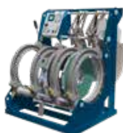
Welda 500 Soldadura manual de tubos a tope Ø250-500 mm
