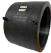
Serie 1200/00 Manguito PE100 SDR11-26: Agua PN16/Gas 10 Bar SDR17-26: Agua PN10/Gas 6 Bar d355-400
