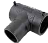
Serie 1204/01 Te Igual PE100 Agua PN16/Gas 10 Bar d20-250
