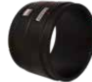
Serie 1200/10 y 1200/20 Manguito de gran diámetro PE100 SDR11-26: Agua PN16/Gas 10 Bar SDR17-26: Agua PN10/Gas 6 Bar d450 - 630 (d710-1200 Bajo pedido)
