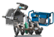
Welda 2 – Soldadura a tope manual 180 - 400 mm
