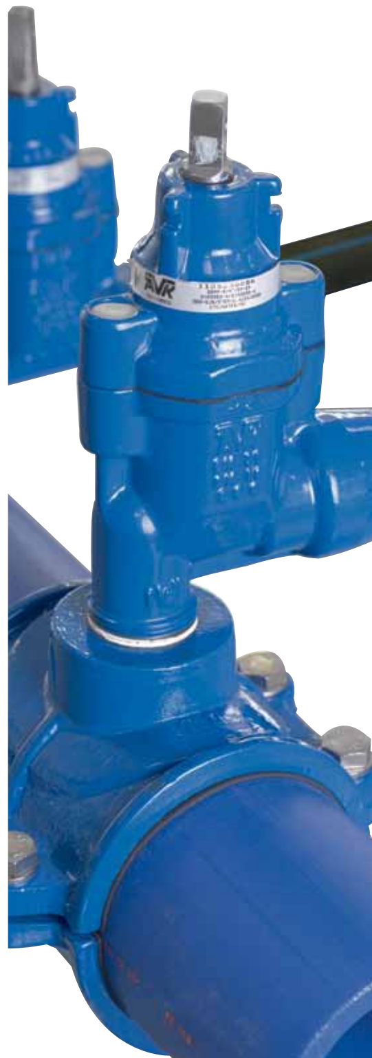
Serie 727/08: Collarín de toma en carga SWIC para tubos de fundición dúctil, fibrocemento y acero DN 80-300, BSP /NPT ½-2"
