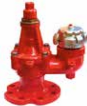
Serie 88 Hidrante enterrado PN16 DN80-100 Fundición dúctil Salida racor Barcelona UNE 23400 Certificado AENOR EN 14339
