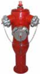
Serie 42 Hidrante de columna seca Profundidad enterrada 300, 350, 450, 550 mm PN 16, DN 80-100 Fundición dúctil Salidas racor Barcelona UNE 23400 Certificado AENOR EN 14384
